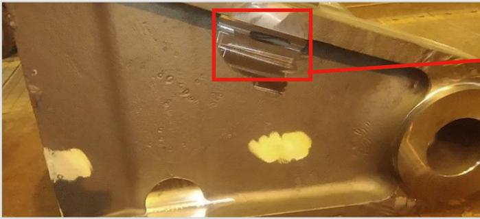
Abb. 17a: Oberfläche des mit HOLLOTEX Shroud gefertigten Gussteils
