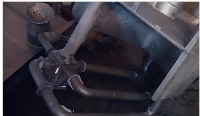
Abb. 15b: Mit HOLLOTEX Shroud gefertigtes Gussteil nach dem Strahlprozess
