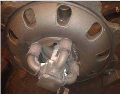
Abb. 12a: Radnabe mit HOLLOTEX Shroud gefertigt
