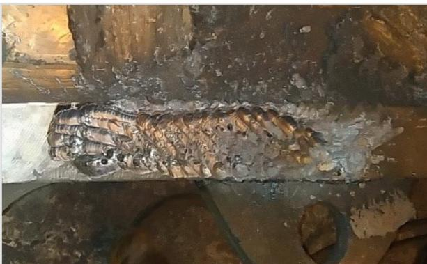
Abb. 14a: Typische Gasblasen an der Oberseite des Gussteils
