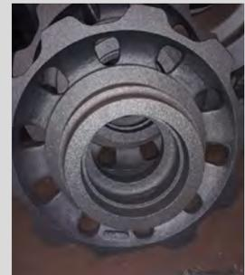
Abb. 12d: Oberseite des Gussteils nach Ultraschall- und Magnetpulverprüfung
