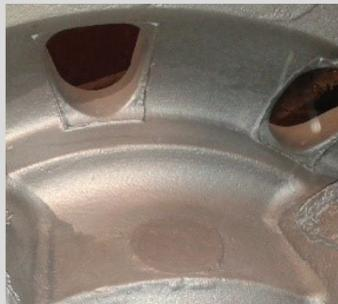
Abb. 12b: Oberfläche des Gussteils im oberen Bereich nach dem Strahlputzen
