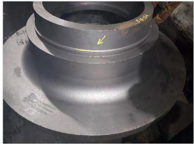
Abb.14d: Gussteil nach der Magnetpulverprüfung
