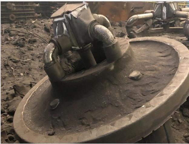
Abb. 13c: Gussteil mit HOLLOTEX Shroud gefertigt
