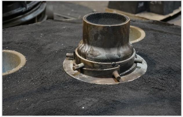
Abb. 5b: Hebesystem auf der Oberseite der Form
