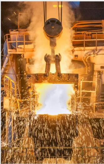
Abb. 2c: Das Anzapfen verursacht Lufteinschlüsse und Doppelfilme.
