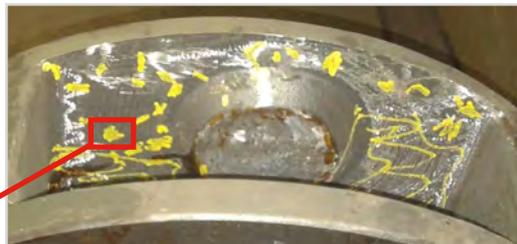
Abb. 10b: Mit konventioneller Gießtechnik gefertigtes Gussteil
