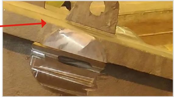
Abb. 17b: Oberfläche frei von Sandstellen oder Gasblasen
