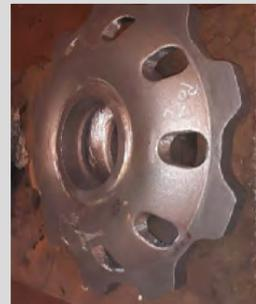
Abb. 12c: Magnetpulverprüfung nach dem Abschrecken
