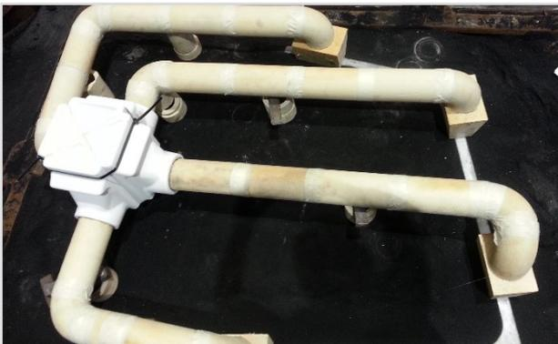
Abb. 15a: Aufbau des Filtergehäuses der HOLLOTEX Shroud und des Gießsystems
